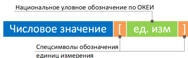
Рисунок 4.2.11 – Схема формирования значений для количественных атрибутов с единицами измерения
