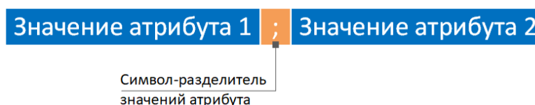
Рисунок 4.2.12 – Схема формирования перечислений в значениях атрибутов элементов
